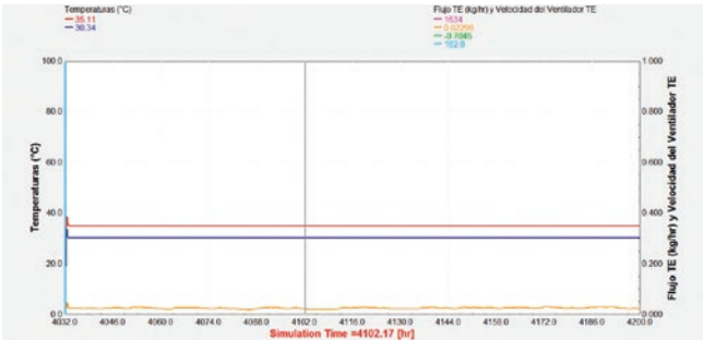
Figura 6. Temperatura de entrada y salida de agua de la torre de enfriamiento y velocidad del ventilador controlado con control PI
